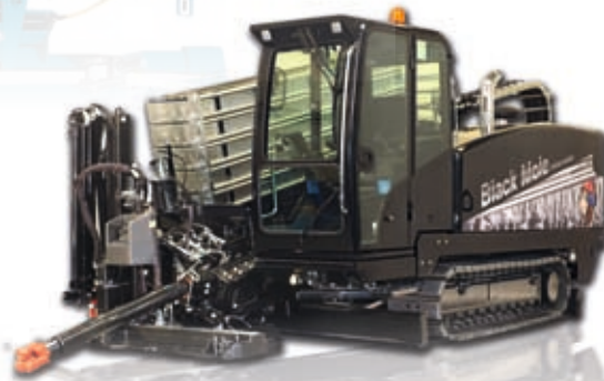
GRUNDODRILL - Spülbohranlagen 4 - 25 t Schub- u. Zugkraft, für die Rohrverlegung bis Ø 700 mm Typen: 4X, 15XP, 25N und Felsbohrmaschine 18ACS
